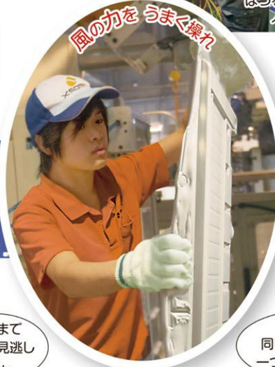
←ブロー成形は 風を吹き込んで つくるから、 製品の中は空洞
