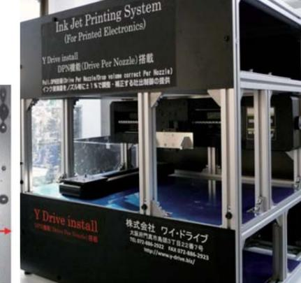
DPN機能搭載インクジェット印刷装置
